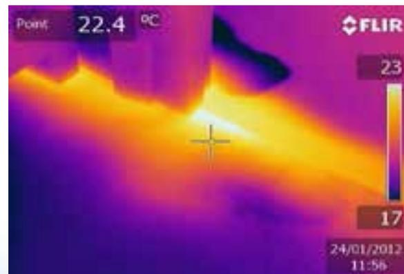
LAS FUGAS DE AGUA EN EDIFICIOS RESIDENCIALES PUEDEN TENER GRAVES CONSECUENCIAS. PUEDEN PROVOCAR PROBLEMAS CON LA INTEGRIDAD ESTRUCTURAL, FORMACIÓN DE MOHO Y, EN CASO DE FUGAS EN LAS TUBERÍAS, TAMBIÉN PUEDE OCASIONAR EL AUMENTO DEL IMPORTE DE LAS FACTURAS DEL AGUA. LA TERMOGRAFÍA MUESTRA CLARAMENTE QUE HAY UNA TUBERÍA DE AGUA CALIENTE DEBAJO DEL SUELO CON UNA FUGA.
