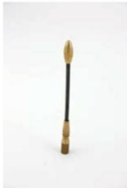
PARA DETERMINAR EXACTAMENTE EL EXTREMO DE LA BARRA DE FIBRA DE VIDRIO SE UTILIZA UN RASCATUBOS PEQUEÑO. ESTE PEQUEÑO TRANSMISOR GENERA SU PROPIO CAMPO QUE SE DETECTA CON PRECISIÓN CON UN RECEPTOR. LA PROFUNDIDAD TAMBIÉN SE PUEDE MEDIR CON EXACTITUD. EL RASCATUBOS PEQUEÑO PUEDE UTILIZARSE SIN BARRA DE FIBRA DE VIDRIO.
