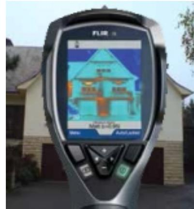
LOS TERMÓMETROS DE INFRARROJOS (IR) SON FIABLES Y MUY ÚTILES PARA LECTURAS DE LA TEMPERATURA DE UN SOLO PUNTO. SIN EMBARGO, AL ANALIZAR ZONAS DE MAYOR TAMAÑO, ES FÁCIL NO PERCIBIR PROBLEMAS CRUCIALES, COMO FUGAS DE AIRE, ZONAS CON UN AISLAMIENTO DEFICIENTE O FILTRACIÓN DE AGUA. UNA CÁMARA TERMOGRÁFICA PUEDE ESCANEAR EDIFICIOS COMPLETOS, INSTALACIONES DE CALEFACCIÓN Y DE CLIMATIZACIÓN. NUNCA FALLA A LA HORA DE DETECTAR UNA ZONA CON POSIBLES PROBLEMAS, NO IMPORTA LO PEQUEÑA QUE SEA.
